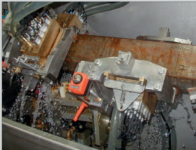
4組探頭架（每組7個探頭）定位在方形的鋼坯的每一面，藉由滾輪及堅硬金屬擋板導引檢測
